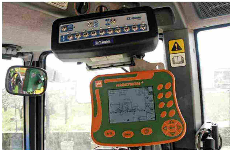
Computer nella cabina di un trattore per il controllo dell'irroratrice
